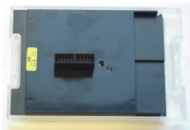
Slika 2: Zaštita od neovlaštena pristupa mjeriteljskim parametrima računске jedinice INFOCAL 5 nakon ovjeravanja
